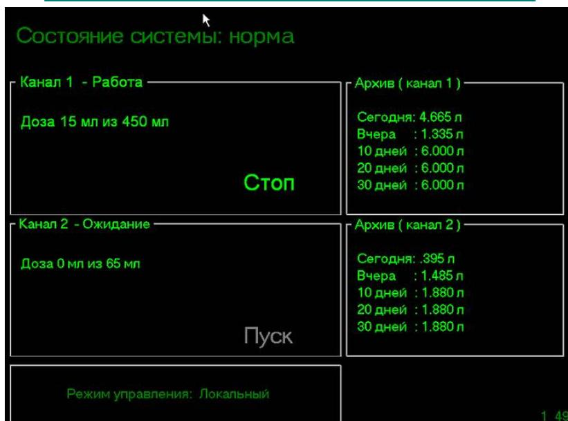
Система управления поддерживает два режима работы: локальный и дистанционный. Режим работы индицируется в нижней части экрана. Смена режима работы производится при нажатии на надпись «Режим управления».
