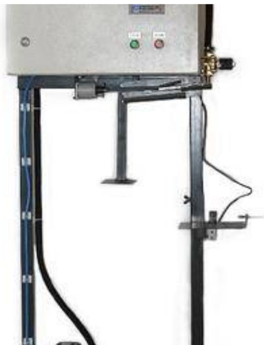
При нажатии оператором кнопки «ПУСК» на панели управления, происходит открытие клапана и включение насоса. При достижении веса равного величине первой уставки производится изменение производительности насоса, по набору полного веса (уставка 2) насос останавливается, клапан закрывается.
