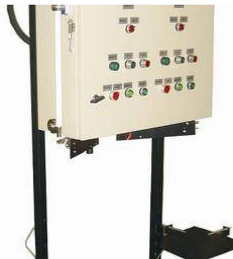
Дозатор используется для дозирования технических жидкостей методом взвешивания, в процессе дозирования дозатор управляет собственными исполнительными механизмами – устройством подъема-опускания подающего патрубка, устройством отсечки последней капли отсечным электромагнитным клапаном и внешним 3-х фазным насосом.
