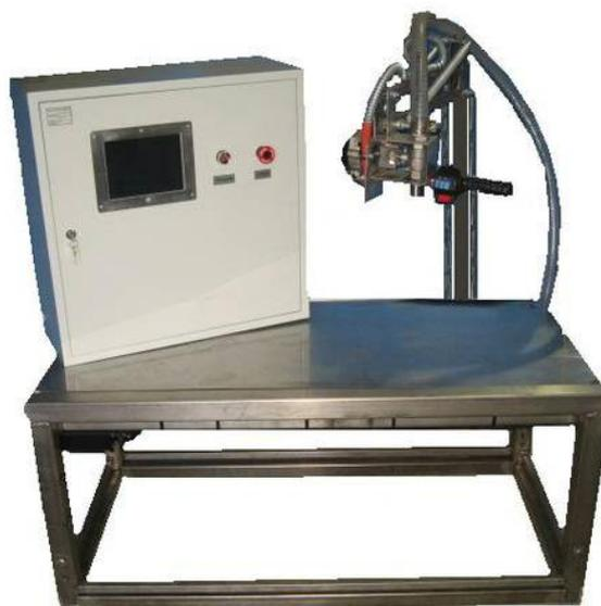
Для экстренного отключения подачи продукта на штанге розлива установлен тумблер (рычажный выключатель) и аварийный выключатель на шкафу управления.
